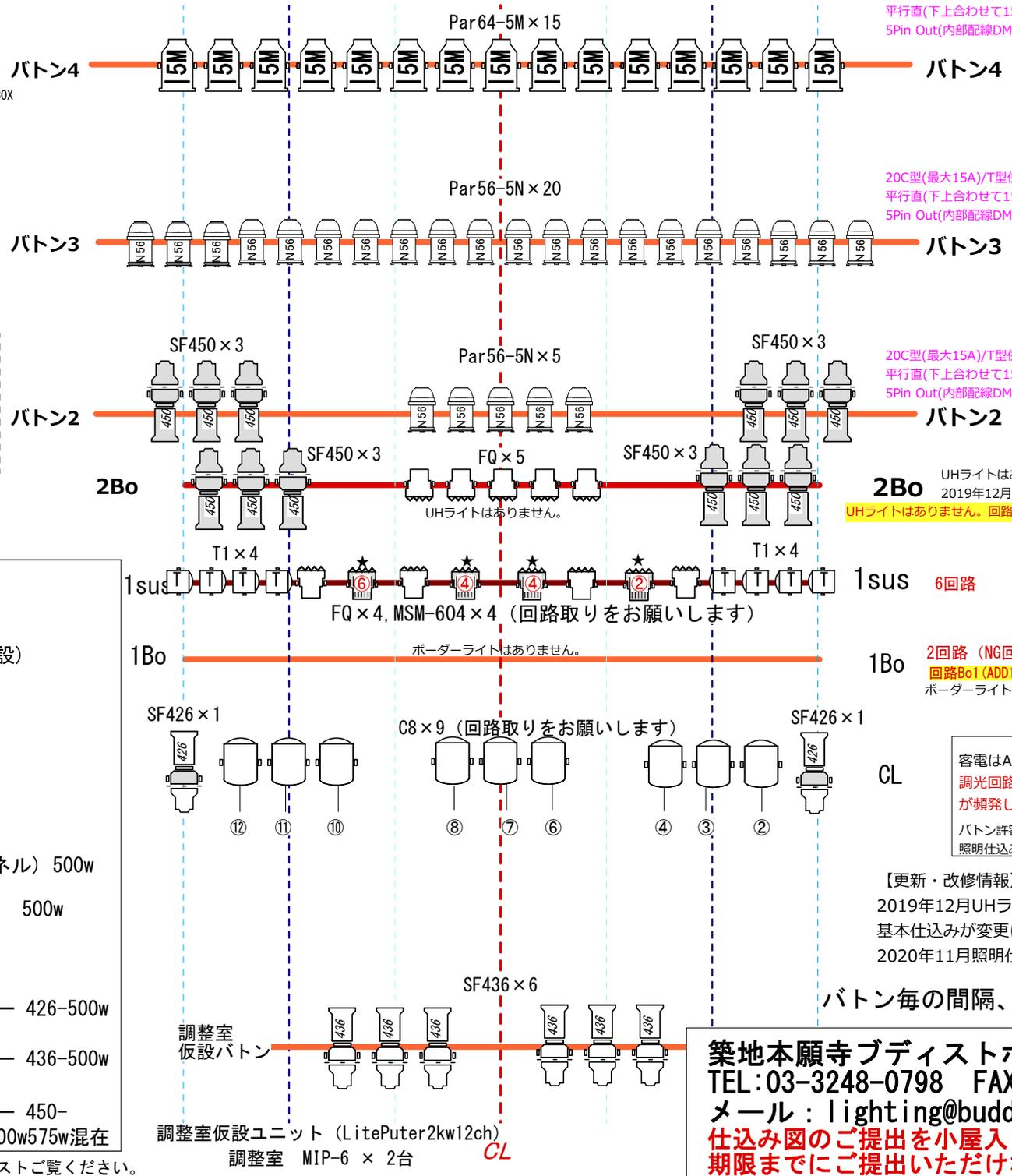
20C型(最大15A)/T型併設 ユニットまで立ち降ろし 下上各4回路(合計8回路)
